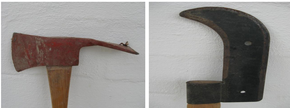
Figura 16. Pulasky y rozón utilizados en la extinción de incendios forestales
