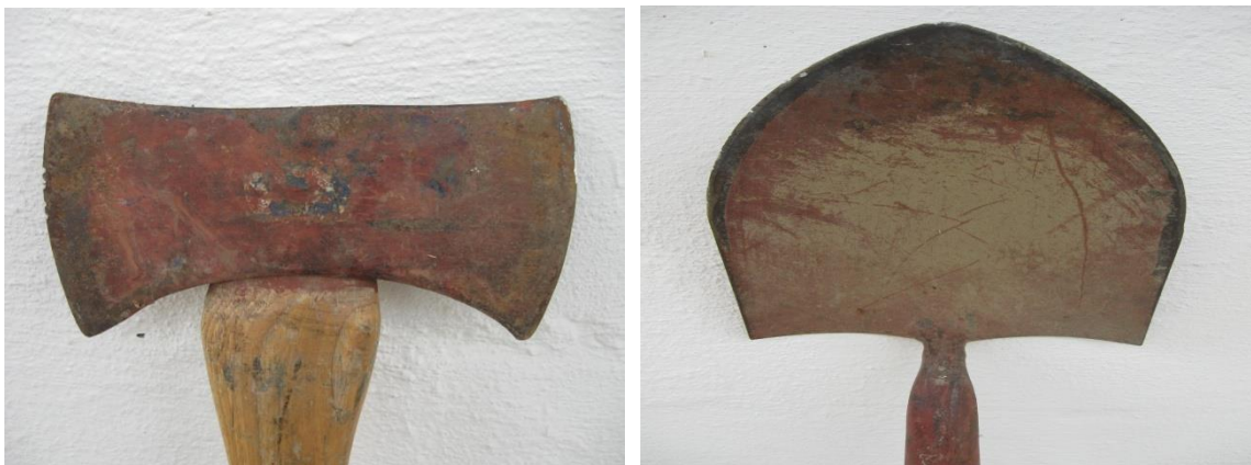
Figura 18. Hacha y palín utilizados en la extinción de incendios forestales
